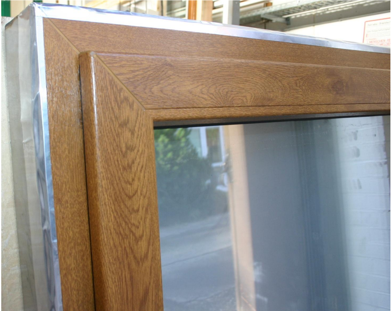
Anlage 5 Bild des Probekörpers ( Detail Einbau in Aluminiumschale)
