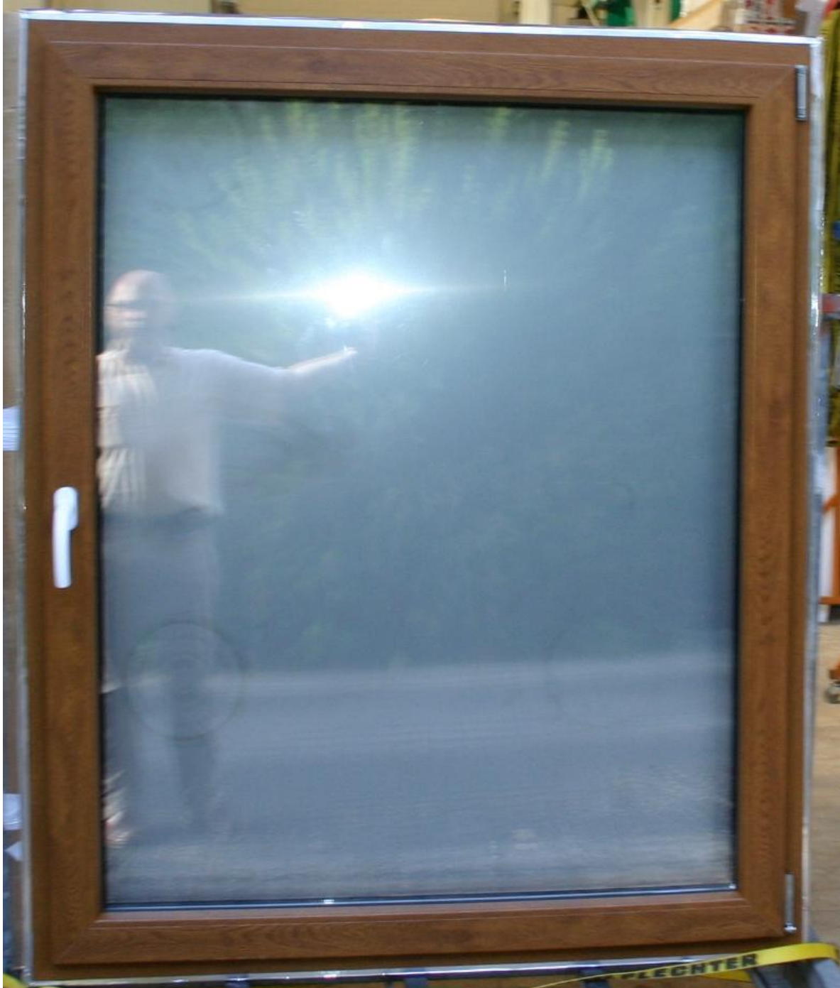
Anlage 4 Bild des Probekörpers (Aussenseite Luftdicht abgedichtet)
